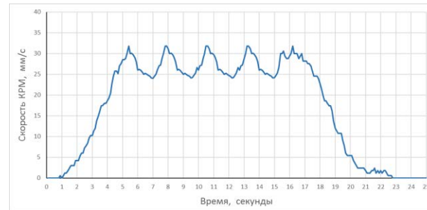
Неисправность одного из двух редукторов, приводящих в движение стол карусели
